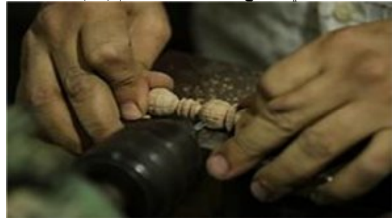
شكل ٢٦ الجانب الاقتصادي يتجلى في استغلال قطع الاجزاء الخشبية الصغيرة من بقايا عمل الاسقف والابواب والنوافذ والاثاث يتم خرطها يدوياً ثم تجميعها في شبكات لتكوين المشربية .
